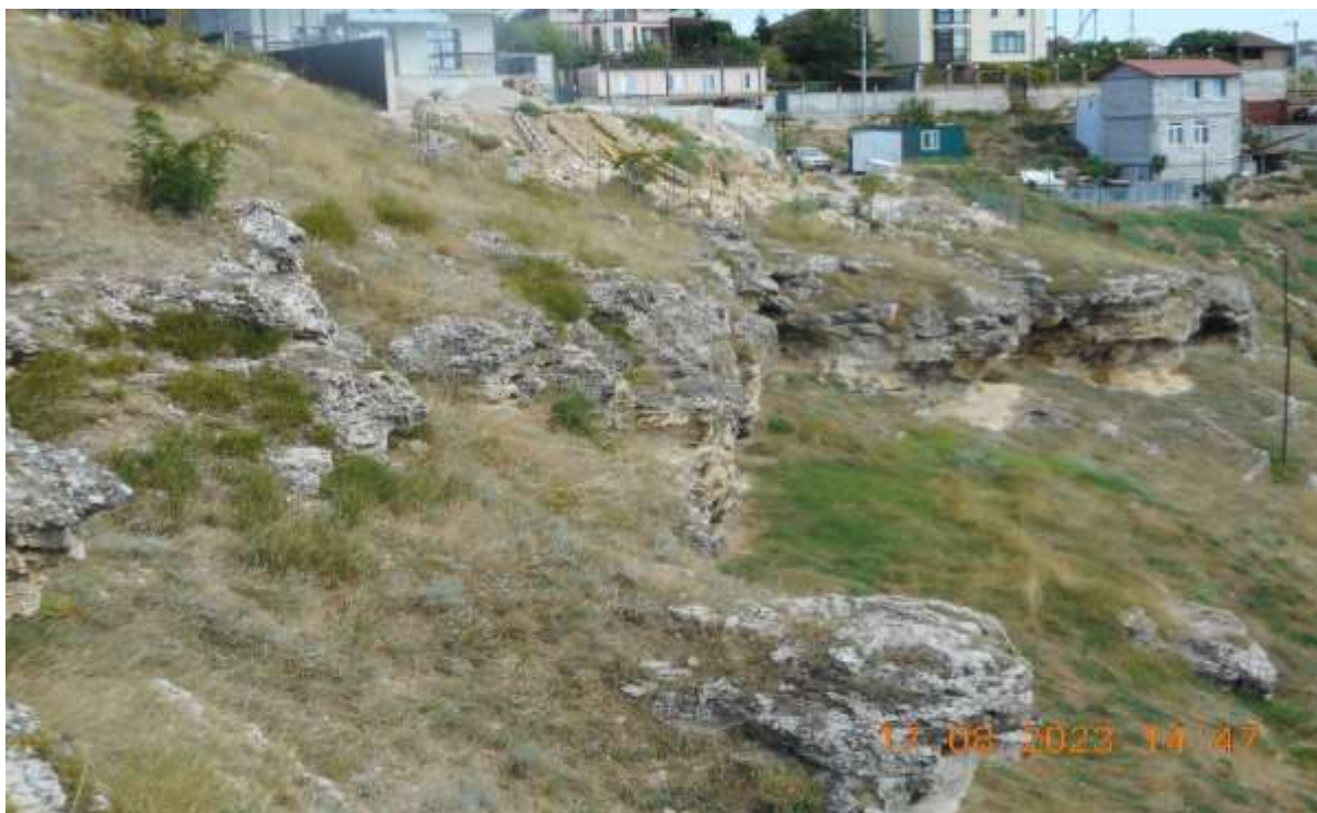
Рис. 2.29 Нависающие блоки горных пород в верхней части склона
