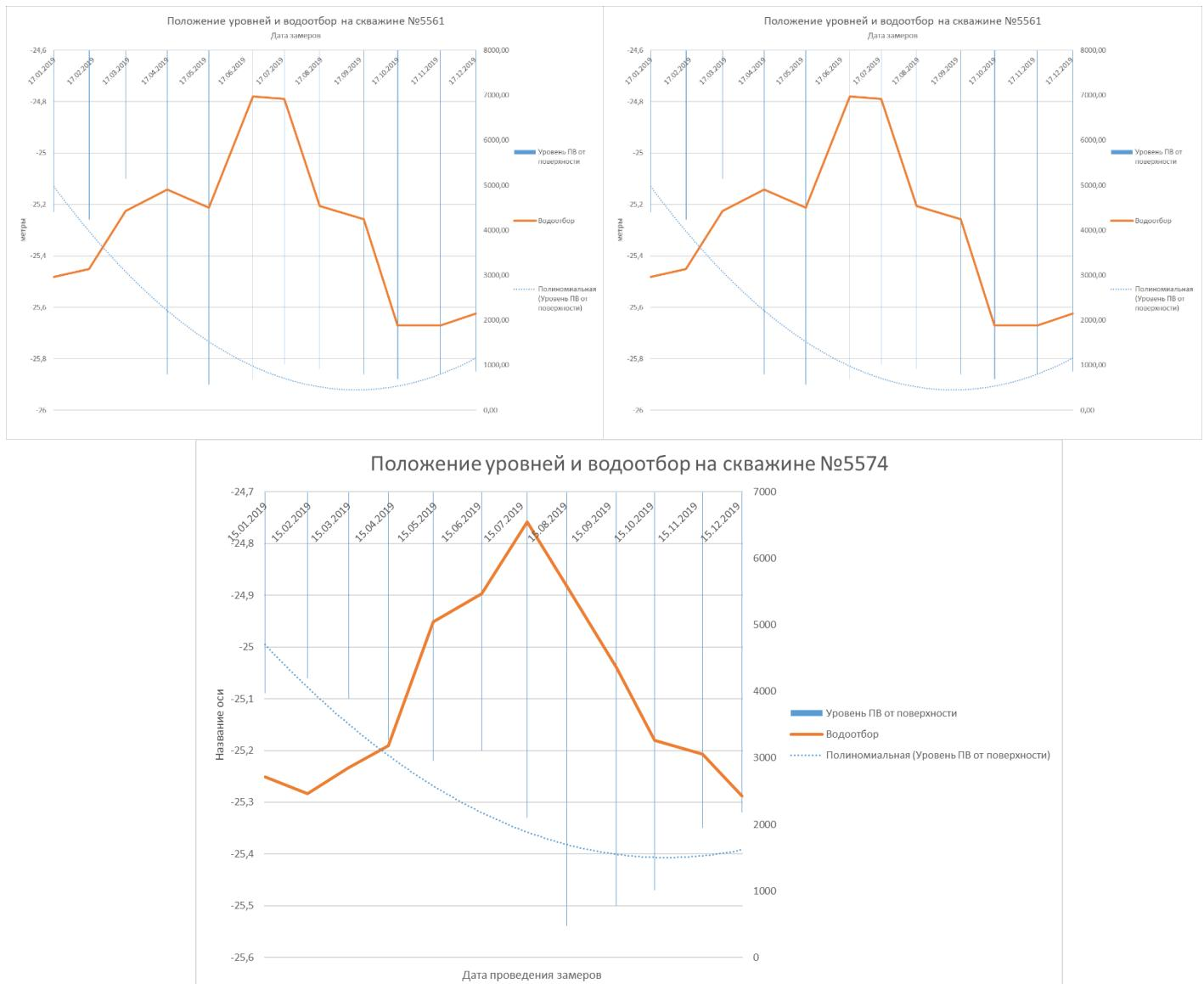
Рис. 1.16 Водоотбор и положение уровня ПВ на скважинах ОНС
