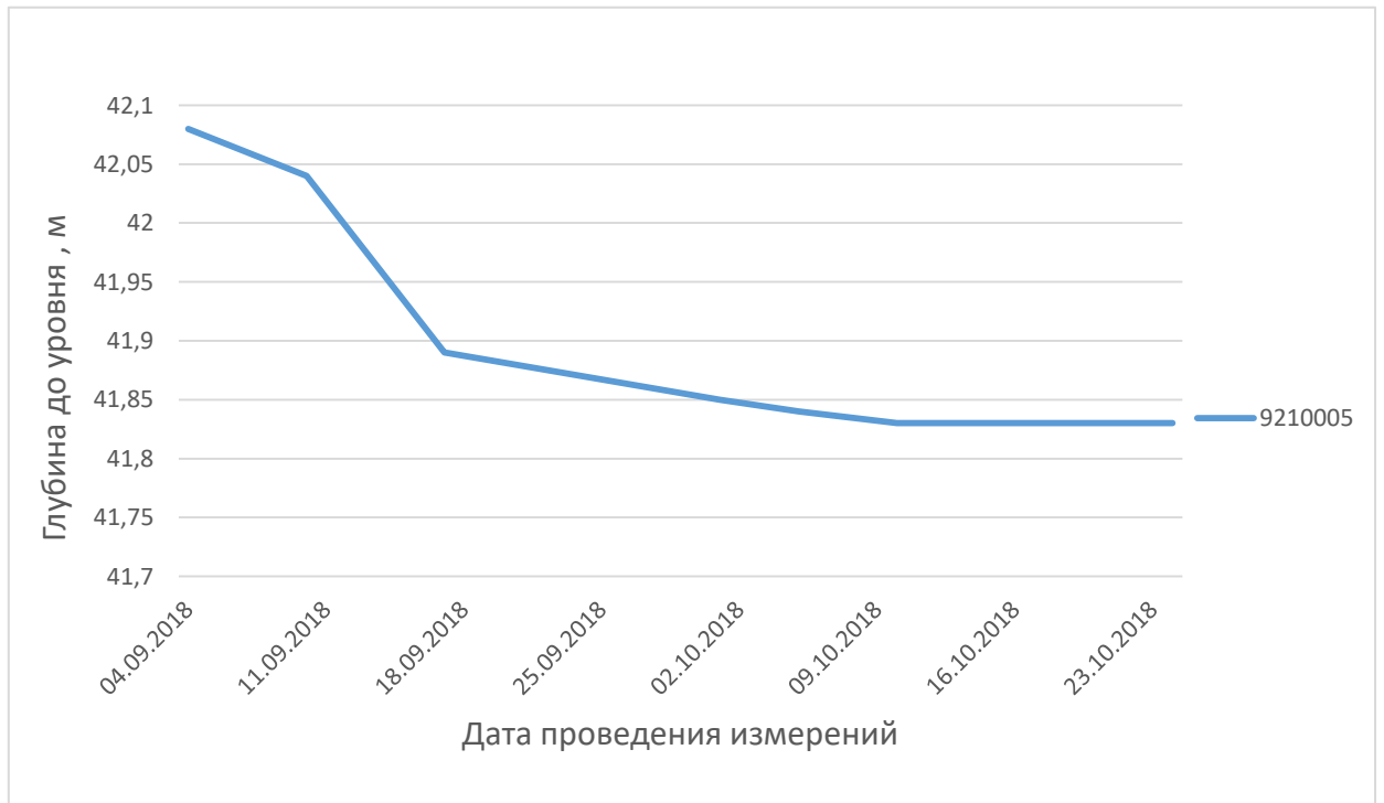
Рис. 1.3.3 Многомесячные изменения уровней грунтовых вод среднемиоценового водоносного горизонта
